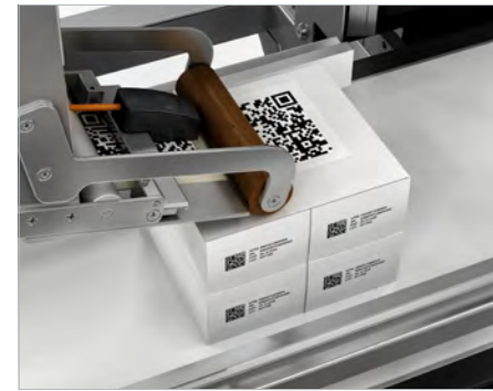
Professionelle Bündel etikettierung mittels TQS-BP
